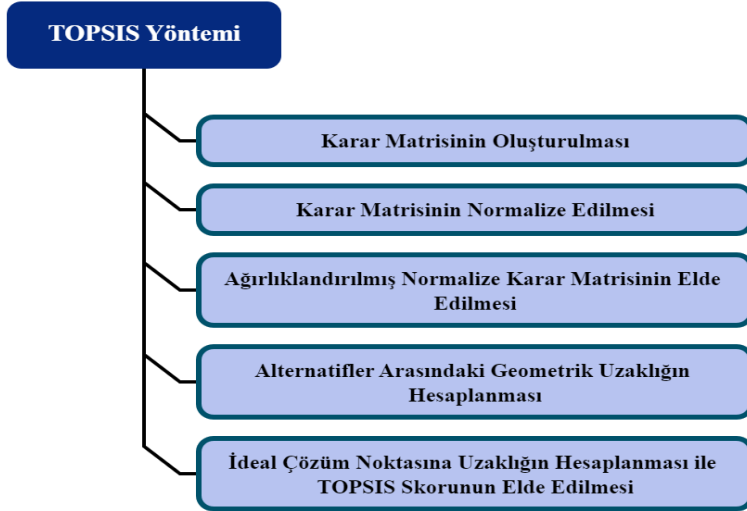
Şekil 1: TOPSIS Yöntemi Uygulama Adımları
