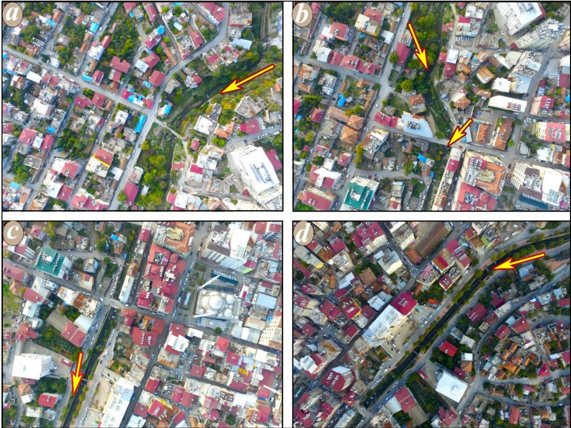
Şekil 3: a) Havzadaki ana akarsuyun doğal yatađı, b) kanalla buluştuđu nokta ve c-d) kanal yapısının drone görüntüsü (oklar akarsu yatađını/kanalı göstermektedir) (Lokasyon: 36°29'49.56"K - 36°21'11.47"D)
