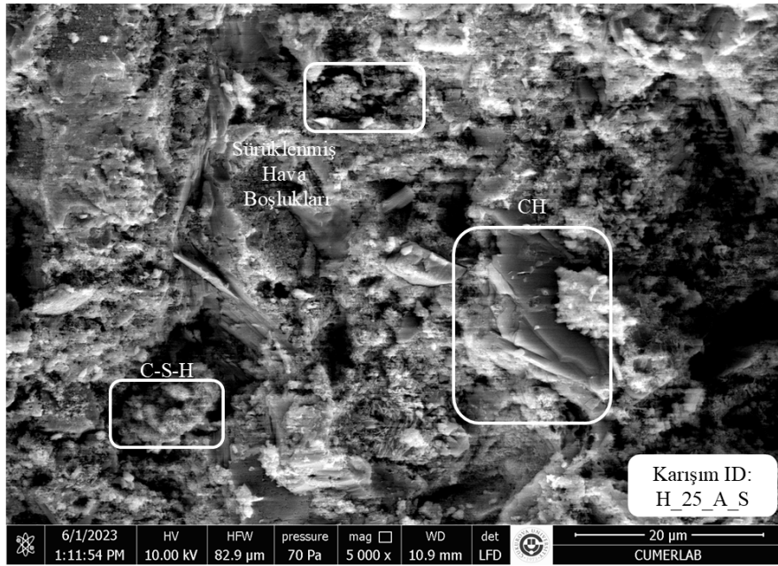
Şekil 11. H_25_A_S karışımı SEM görüntüleri (SEM images of H_25_A_S mixture)
