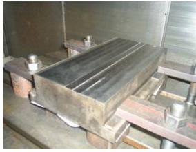
Resim 3. Kalıp çeliği (1.2738) P20
