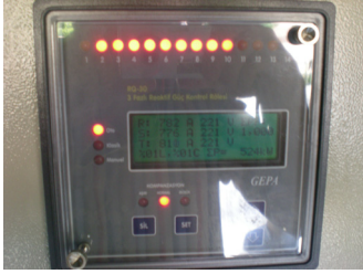
Resim 2. ÜÇ FAZ KONTROLLÜ REAKTİF GÜÇ KONTROL RÖLESİ
