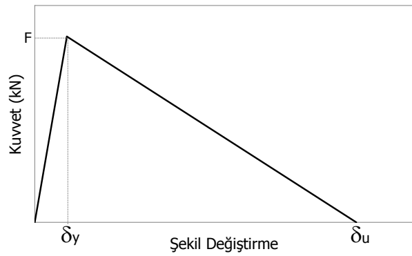
Şekil 9. Sıvanmamış ve sıvanmış boşluklu tuğla dolgu duvarı modelleyen basınç çubuğunun basitleştirilmiş yük-deformasyon eğrisi
