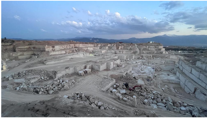
Şekil 3. Ballık bölgesinde (Çal/Denizli) açık işletme yöntemiyle traverten üretimi yapılan ocaktan görünüm
