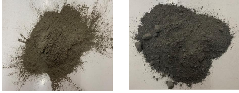
Şekil 2. Araştırmada kullanılan F-sınıfı uçucu kül ve silis dumanı (F-class fly ash and silica fume used in the study)
