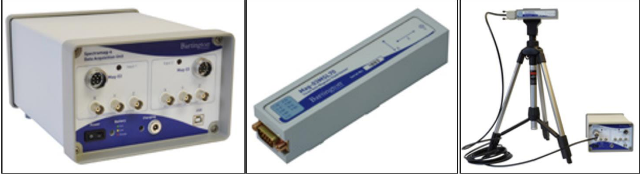
Şekil 10. Flux-Gate manyetometre veri toplama modülü, algılayıcı birim ve sistemin kurulu hali. Figure 10. Flux-Gate magnetometer data acquisition module, sensor unit and the installed state of the system.
