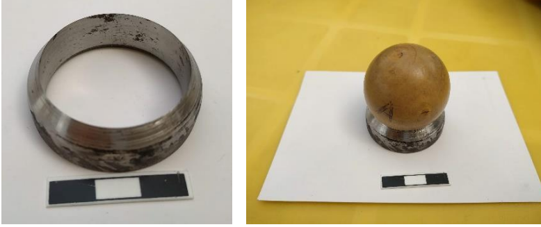
Şekil 5. Bir Kenarı Keskinleştirilmiş Rulman.
