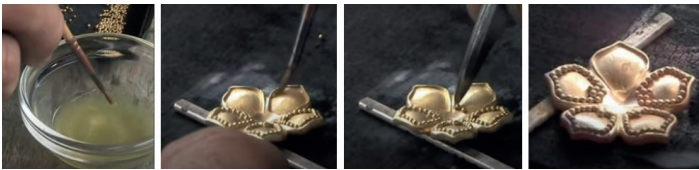
Görsel 5. Granüllerin iş parçası üzerine yerleştirilmesi (URL 7).
