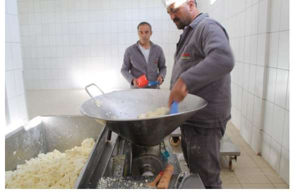
Şekil 3. Baskılanmış Telemenin Makinede Parçalanması. Figure 3. Cutting of Pressed Curd in the Machine.
