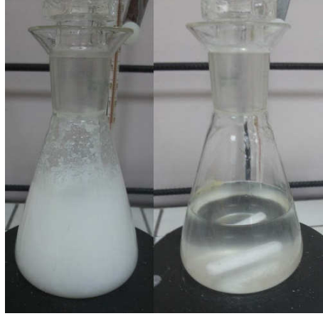
Şekil 2. Alüminyum tri-sec-bütoksitin hidrolizi.
