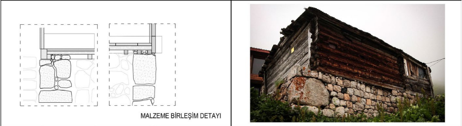
Şekil 19. Taş ve ahşap birleşim detayı (Kaynak: Yazarlar).
