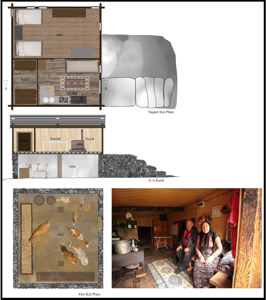
Şekil 13. Ahırlı ev tipine dair plan ve kesit (Kaynak: Yazarlar).
