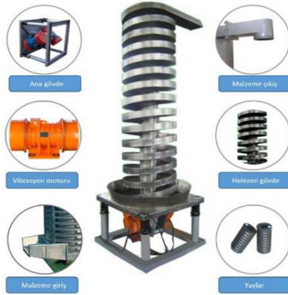
Şekil 1. Vibrasyonlu Dikey Helezon Konveyör [15]
