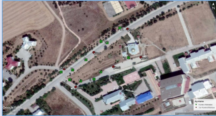
Şekil 2. Çalışma alanı içinde ve YKN ve Kontrol Noktalarının dağılımları [4] Figure 2. Distribution of GCP and Control Points within the work area [4]
