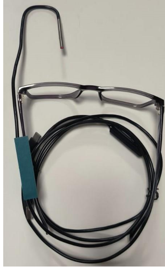
Figure 1. Eyeglass frame, camera, and holder (Gözlük çerçevesi, kamera ve tutucu)
