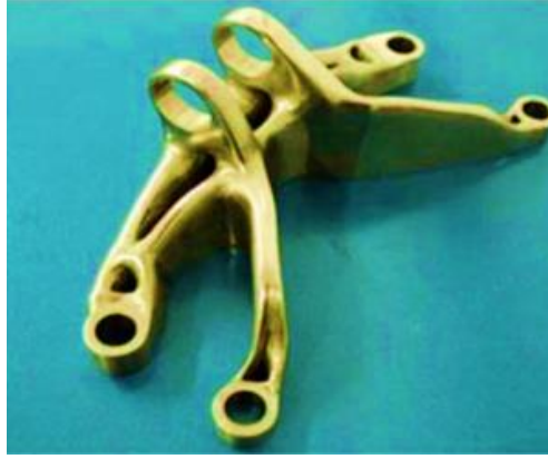
Şekil 1: Uçak braketlerinin geliştirilmesinde topoloji optimizasyonu ve metal eklemeli imalatın uygulama örneği [14].
