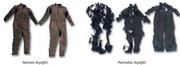
Şekil 5: Koruyucu kıyafet ve normal kıyafetin yangın sonrası görüntüsü [43]
