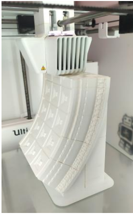
Fig. 13. Üç boyutlu yazıcıda üretim aşaması (Kişisel arşiv)
