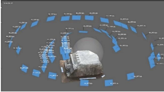
Fig. 10. Fotogrametri yöntemiyle belgelenen bloğun fotoğraflarının Agisoft Metashape Pro programında birleştirilme aşaması (Kişisel arşiv)
