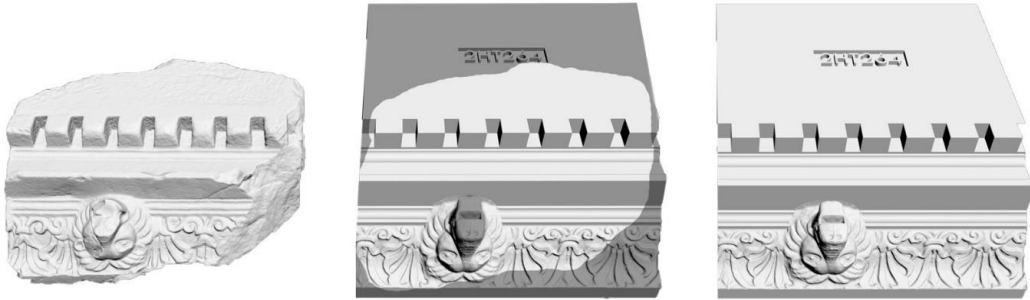
Fig. 12. Maketin üretimi aşamalarında fotogrametrik model, katı modelleme ve organik modelleme desteğiyle üretilen geison-sima bloklarından bir örnek (Kişisel arşiv)
