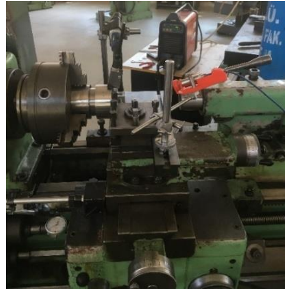
Şekil 1. TIG esaslı IDİ yöntemi deney düzeneği (TIG based HAM method experimental setup)
