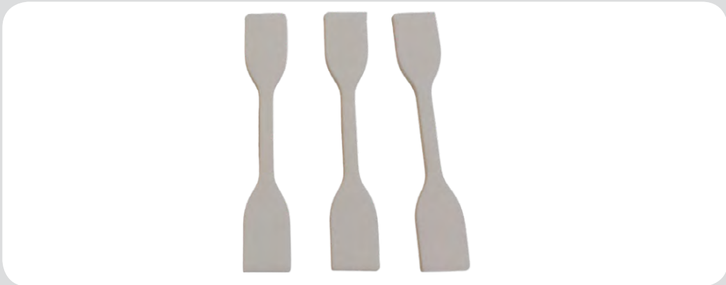
Şekil 2.1 ASTM D638 Tip 4 Göre Basılan Mekanik Test Çubukları
