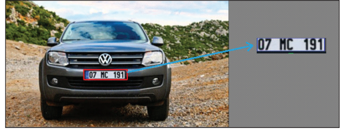
Şekil 5. YOLO algoritması ile plakası bulunmuş ve işaretlenmiş araç görseli.
