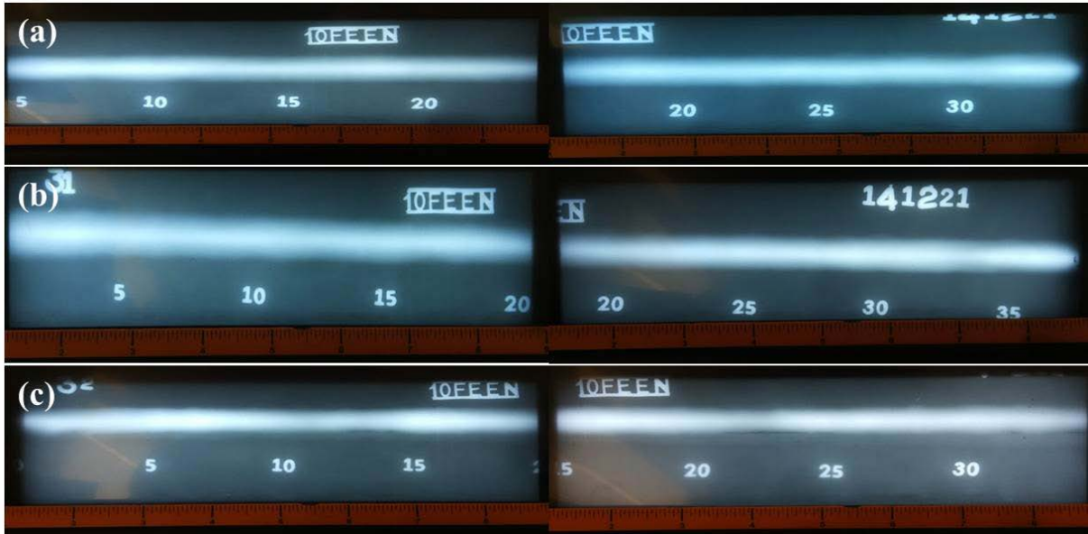
Şekil 2. Radyografik muayene sonuçları (a) S1, (b) S2Si, (c) S3Mo
