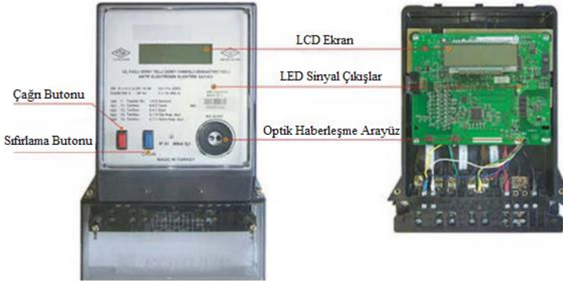
Şekil 1. Üç Fazlı Kombine Sayacın Ön Görünüşü ve İç Bağlantı Şeması
