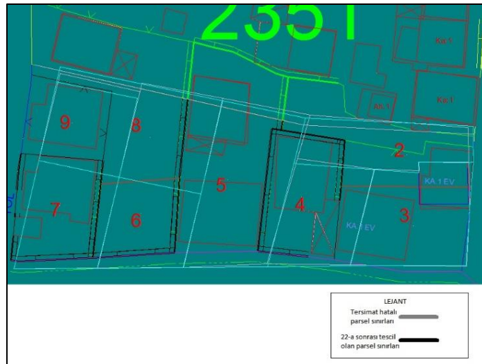
Şekil 6. Ölçme personelinin dikkatsizliği sonucu kadastro planlarında oluşan hataların gösterimi (Osmaniye Kadastro İl Müdürlüğü, 2024).
