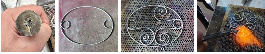
Görsel 33. Süsleme kalıbı, Görsel 34-35. İskelete iç dolgu yerleştirmeye başlanması, Görsel 36. İç dolgusu devam eden tokenın kaynak görmesi (Aday Gürkan Telkâri Atölyesi)
