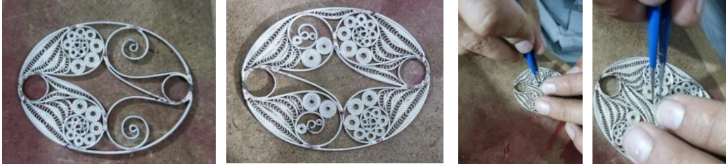
Görsel 41-42. İç dolgusu devam eden toka, Görsel 43- 44. İç dolgunun çift yardımıyla yerleştirilmesi (Aday Gürkan Telkâri Atölyesi)
