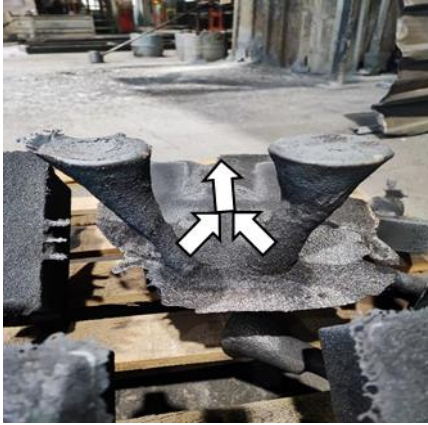
Şekil 2. Çift yolluk kullanılarak farklı oranlarda döküm işleminden sonraki oluşan yolluk sistemi (The guide system formed after casting at different rates using double guides)
