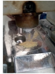
Şekil 16. İçeriğin tablet basma cihazı haznesine yerleştirilmesi.
