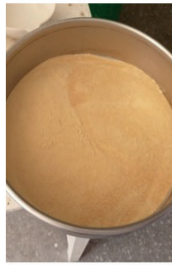
Şekil 8. Eleme işlemi sonrası 35 mesh boyutuna getirilen limon kabuğu tozu.
