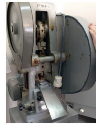
Şekil 17. Manuel ilaç makinesinde tabletin basılması.
