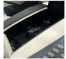
Şekil 31. Spektrofotometrik okuma için viyallerdeki numunelerin spektrofotometreye yerleştirilmesi.
