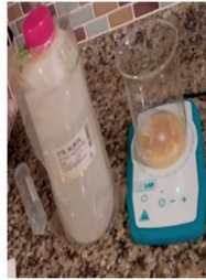
Şekil 23. Limon kabuğu tozunun manyetik karıştırıcıda karıştırılıp, etanolde çözülmesi.
