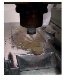
Şekil 18. Limon kabuğu ve kimyasalların efervesan tablet halinde basılması.
