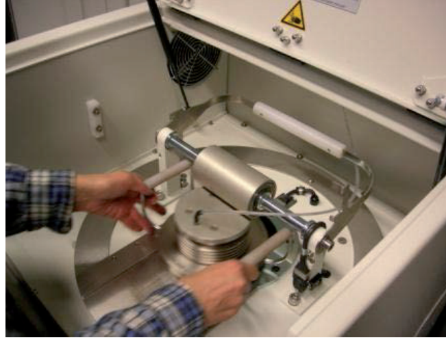
Şekil 4. Öğütme işleminin gerçekleştirildiği halkalı değirmen.
