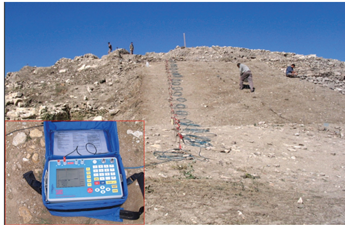
Şekil 4. Otomatik rezistivite cihazı ve çok elektrotlu ölçü düzeniği
