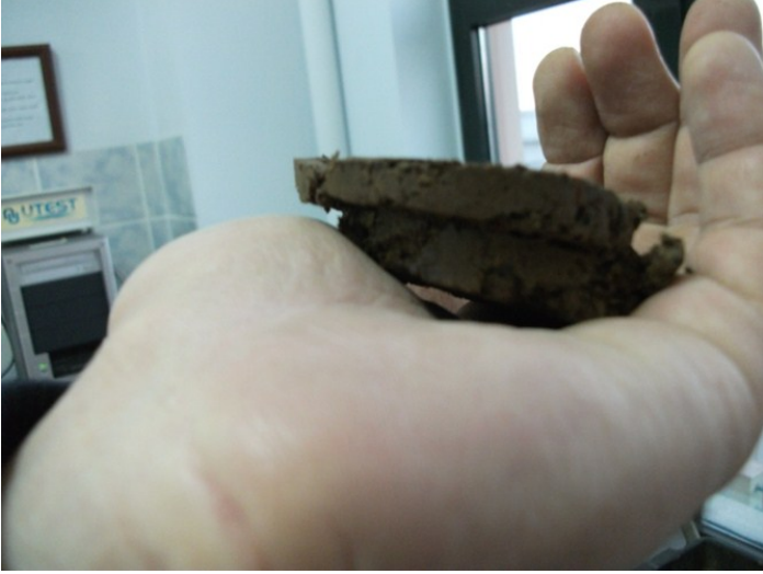
Şekil 2. Kesme kutusunda kırılmış numune
