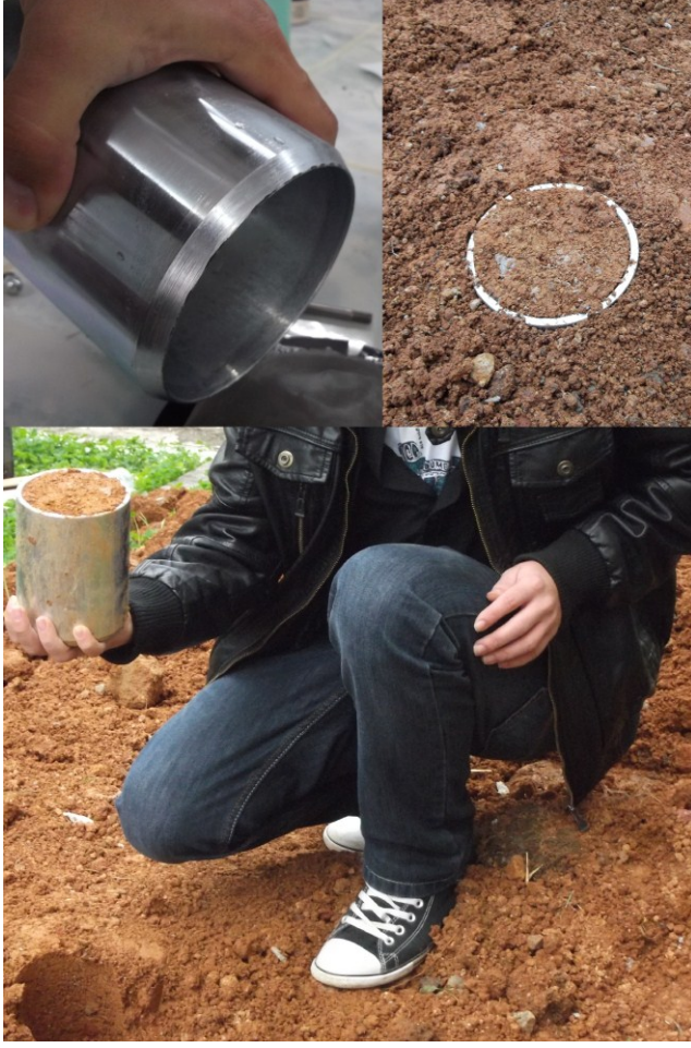
Şekil 24. Permeabilite numune kalıbı ve numune alma
