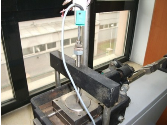
Şekil 15. Numunenin oturma miktarının LVDT ile ölçülmesi
