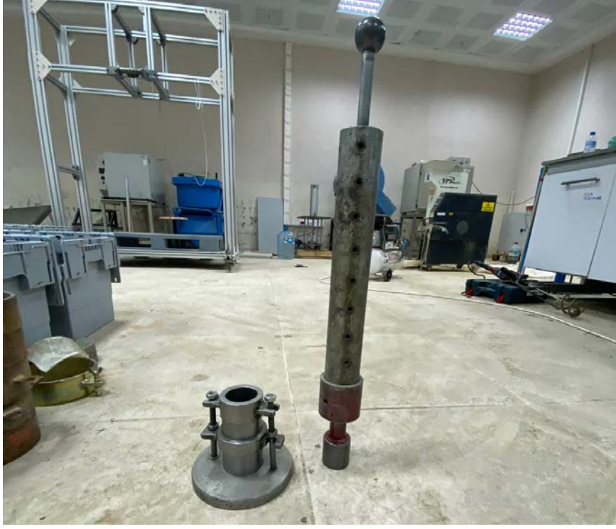
Şekil 6. Serbest Basınç Deneyi için numune oluşturma kabı ve tokmağı
