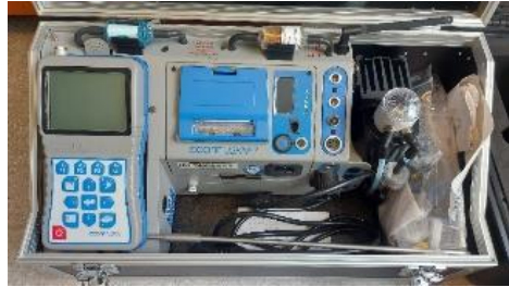
Şekil 5. Ölçümlerde kullanılan baca gazı ölçüm cihazı
