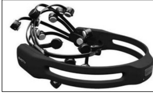
Görsel 12 Emotiv Epoc+ Mobil EEG cihazı
