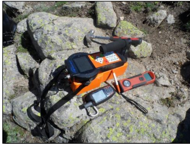
Şekil 5. Kayaç üzerinde gama ışını spektrometre ve manyetik suseptibilite ölçümleri Figure 5. Gamma-ray spectrometry and magnetic susceptibility measurements on the rock
