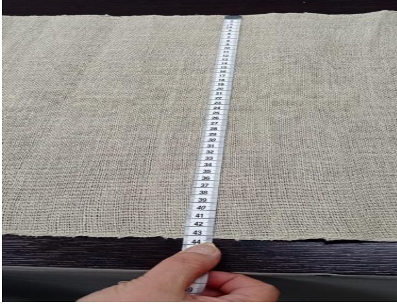
Şekil 14. Kumaş eni ölçülerek (43 cm) pastal planının hazırlanması Figure 14. Preparing the marker plan by measuring the fabric width (43cm)
