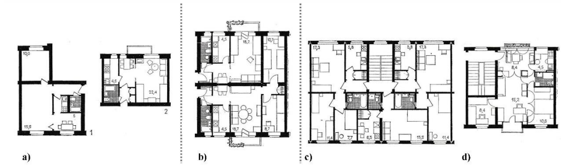
Şekil 9: Tek ailelerin yaşayacağı farklı oda sayısına göre tasarlanmış ekonomik konut plan örnekleri, a) İki odalı daire b) Yarışma Projesi 3.lük ödülü-Stüdyo daire c) Yarışma projesi 1.li ve 2.lik ödülü – Stüdyo ve iki odalı daire d) Kapalı yarışma projesi – küçük alanlı daire (Rubanenko ve Kartashova, 1982, s.31)
