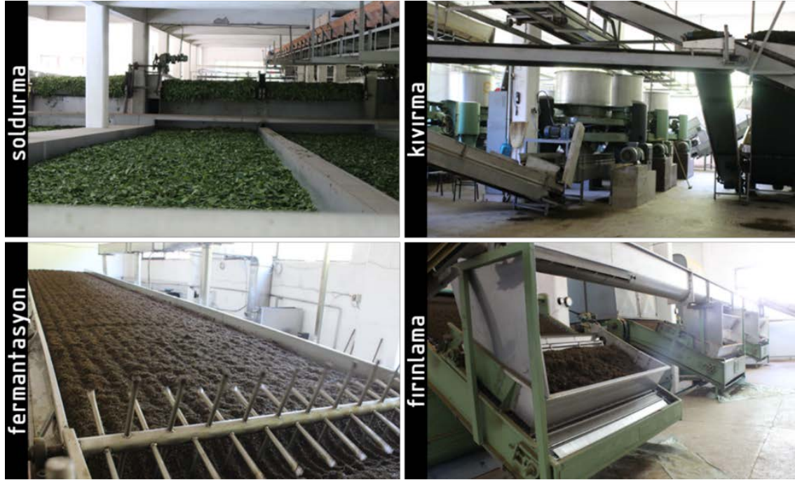
Şekil 7. Yaş çayın üretim aşamaları. Alıntı: Dağçay (2024).
