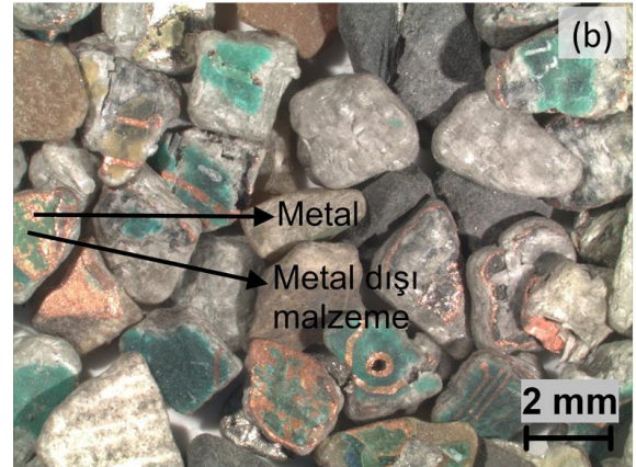
Şekil 5. (a) ABDK'nın (-3,35 mm) tane boyut dağılımı, (b) -3,35+2,36 mm fraksiyonuna ait stereomikroskop görüntüsü
