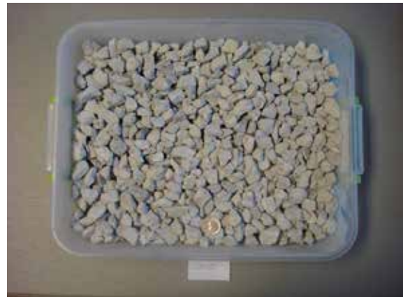
Şekil 4. Laboratuvarda hazırlanan tane boyu bilinen kalsit agregası karışımından bir görünüm
