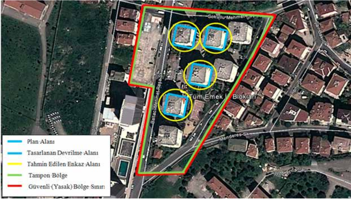
Şekil 15. Yıkımda Oluşturulan Güvenli Bölge (Özer vd., 2013)
