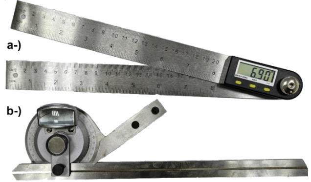
Şekil 1. (a) Dijital açı ölçer, (b) Evrensel açı ölçer
