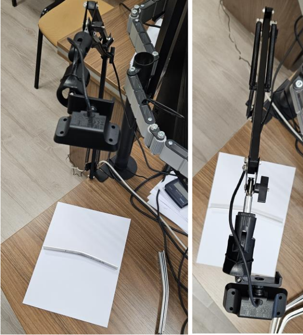
Şekil 3. Kamera düzeneği ile numunelerin fotoğrafının çekilmesi
