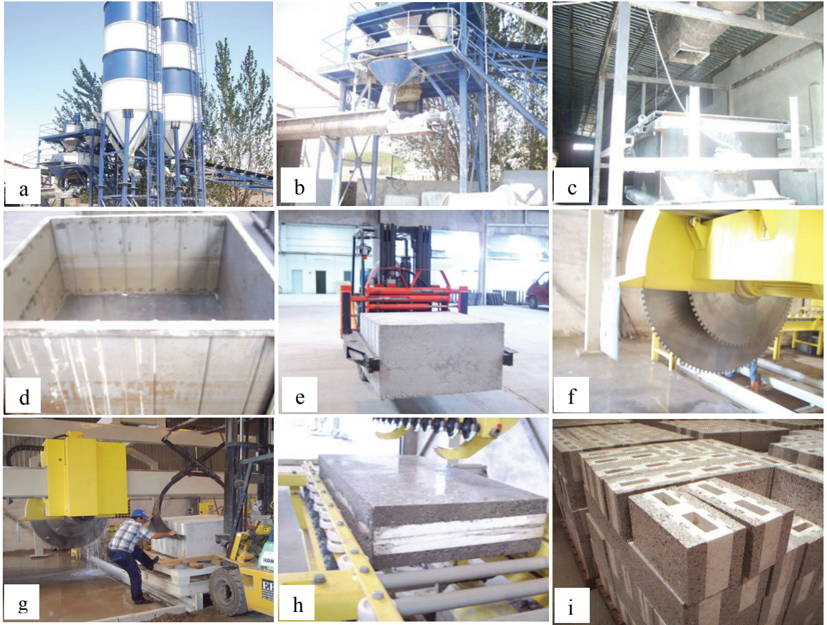
Şekil 3. İzolasyon bloğu üretim tesisinde proses süreci.
