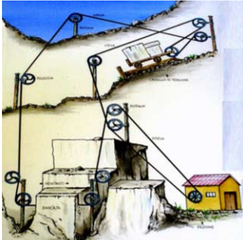
Şekil 1. Helezon telle kesme yönteminin sembolik görünümü.
