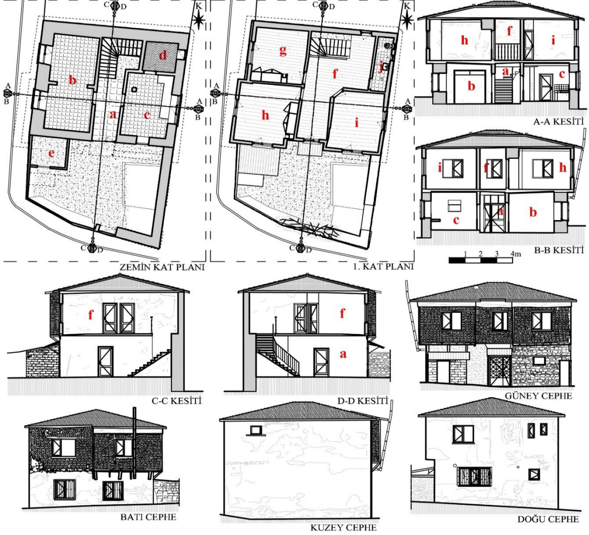
Şekil 3. Tuğla ev rölövesi
