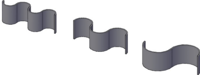
Şekil 8. Deneyleri ve nümerik modelleri oluşturulan harmonik dizilimdeki dairesel labirent savaklar
