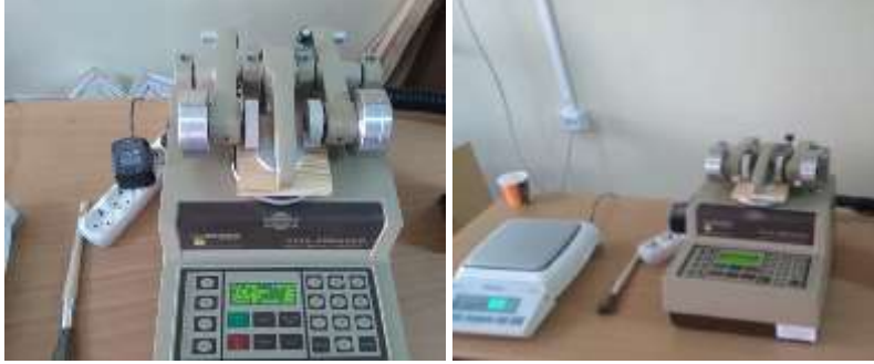
Şekil 5. Deney örneklerinin Aşınma Direnci testi (Abrasion resistance test of experiment samples)
