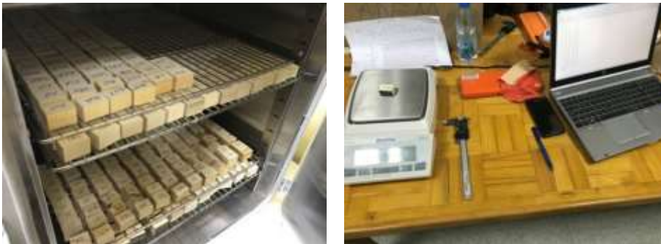
Şekil 4. Örneklerin tam kuru hale getirilmesi ve ölçüm işlemi (Full Drying and Measurement of Samples)
