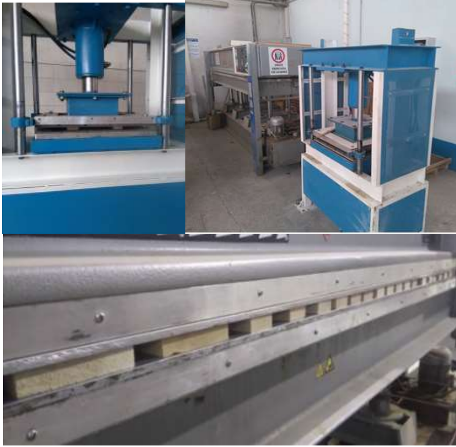
Şekil 2. TVM yoğunlaştırma işlemi ve örneklerin basınç altında soğutulması (TVM densification process and cooling of the samples under pressure)
