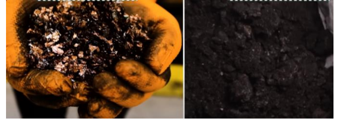
Şekil 5. Mekanik ayrıştırma sonrası açığı çıkan metal folyolar ve kara kütle
