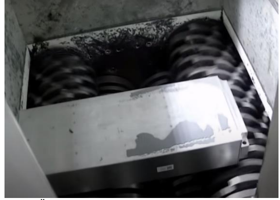
Şekil 4. Ömrünü Tamamlamış Batarya Paketi için Modül Düzeyinde Parçalama Prosesi.
