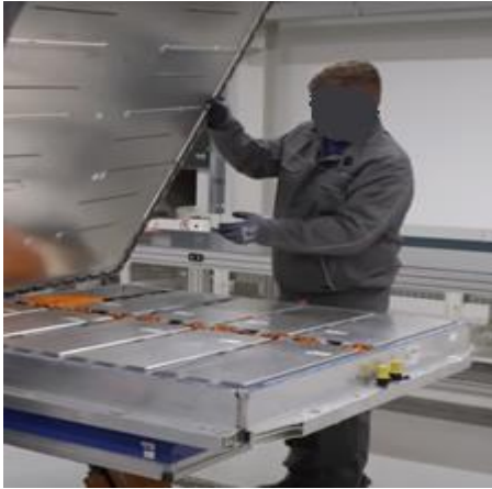
Şekil 3. Ömrünü tamamlamış batarya paketinin ilk demontajı(Volkswagen Group)
