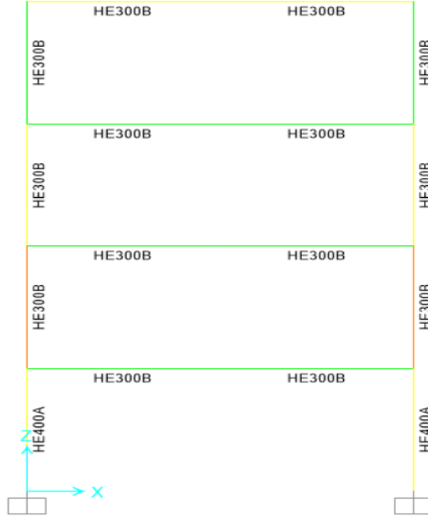
Şekil 10. SAP 2000 Tasarım Sonucu
